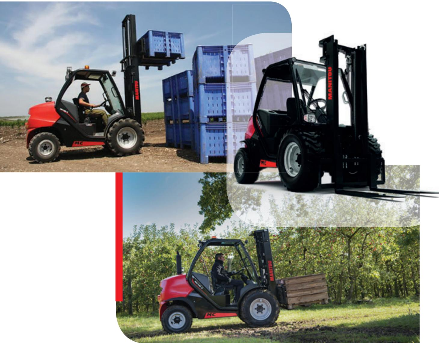
Grâce à sa largeur hors-tout de 1450mm, le chariot élévateur compact tout-terrain MANITOU MC18 est conçu pour la **manutention des charges dans les espaces restreints**, tel des rangs d'arbres fruitiers par exemple.
